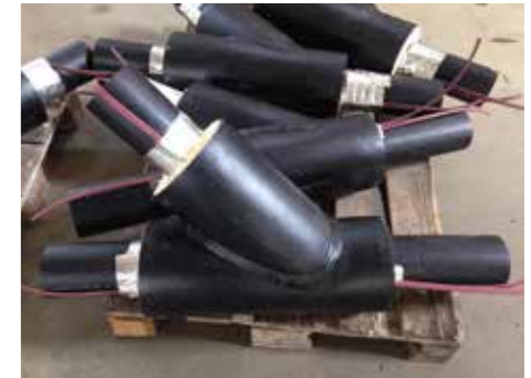
Heizkabel am Rohr montiert
